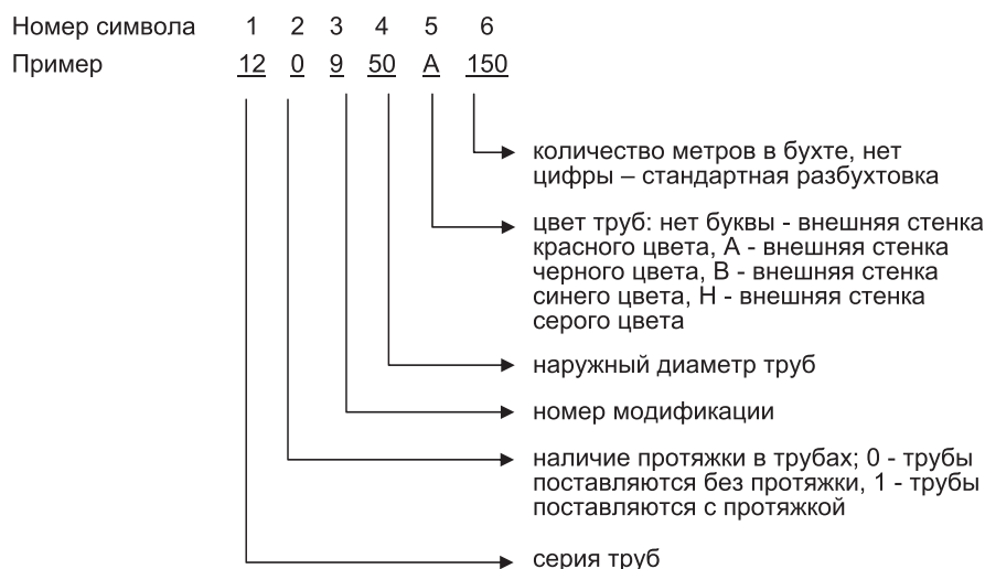
Рисунок 4.1 – Структура условных обозначений двустенных труб ЗАО "ДКС"
